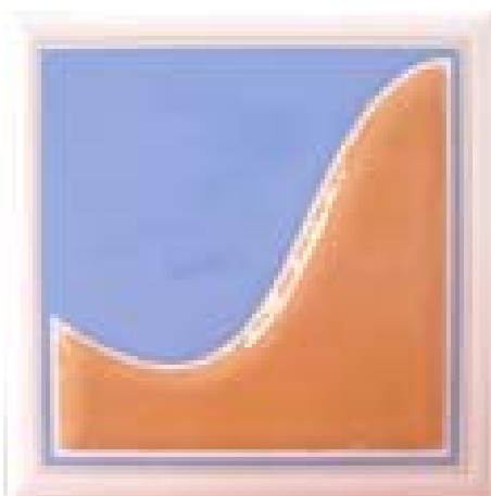
Figura 12. Azulejo decorado com 50% de estanho e 50% de corante, com granilha, em formato 10x10 cm.
