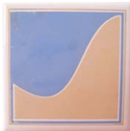
Figura 11. Azulejo decorado com 50% de estanho e 50% de corante, sem granilha, em formato 10x10 cm.
