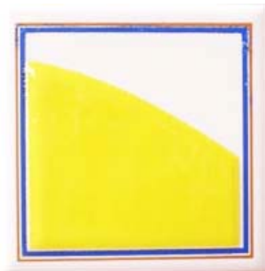
Figura 10. Azulejo decorado com 100% de corante, com granilha, em formato 10x10 cm.
