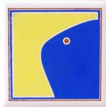
Figura 9. Azulejo decorado com 100% de corante, sem granilha, em formato 10x10 cm.
