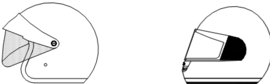
Figura 10 – Capacete aberto e capacete integral ou fechado
