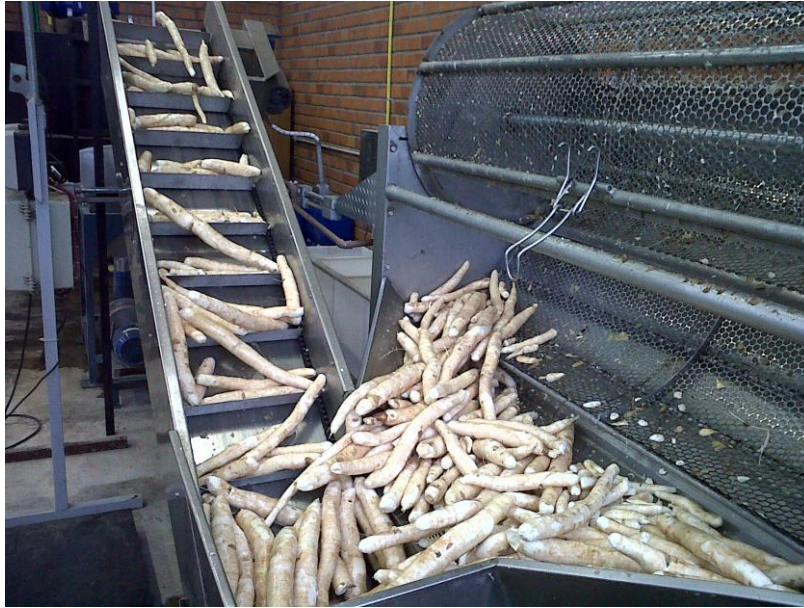
Figura 20 - Esteira transportadora de matéria-prima para moedor Fonte: Arquivo do autor, 2011
