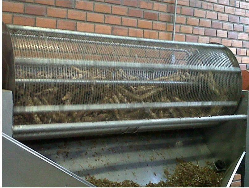
Figura 19 – Vista frontal do lavador rotativo por batelada. Fonte: Arquivo do autor, 2011
