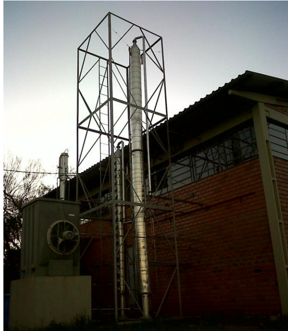
Figura 31 – Destiladora contínua Fonte: Arquivo do autor, 2011
