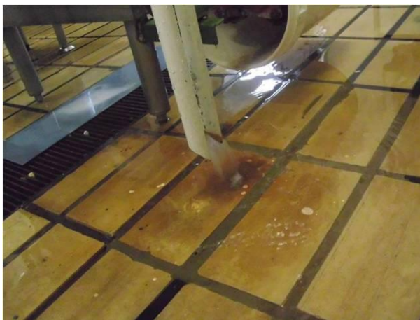
Figura 3 – Perdas de água na pasteurização do leite cru na usina da UFSM
