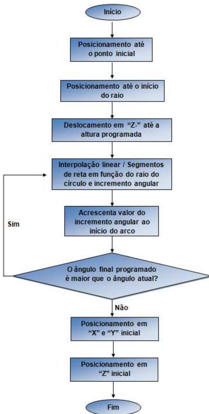
Figura 32 - Fluxograma da programação paramétrica - interpolação circular.
