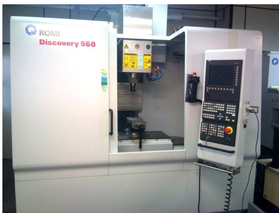
Figura 22 - Centro de Usinagem Vertical Romi Discovery 560.
