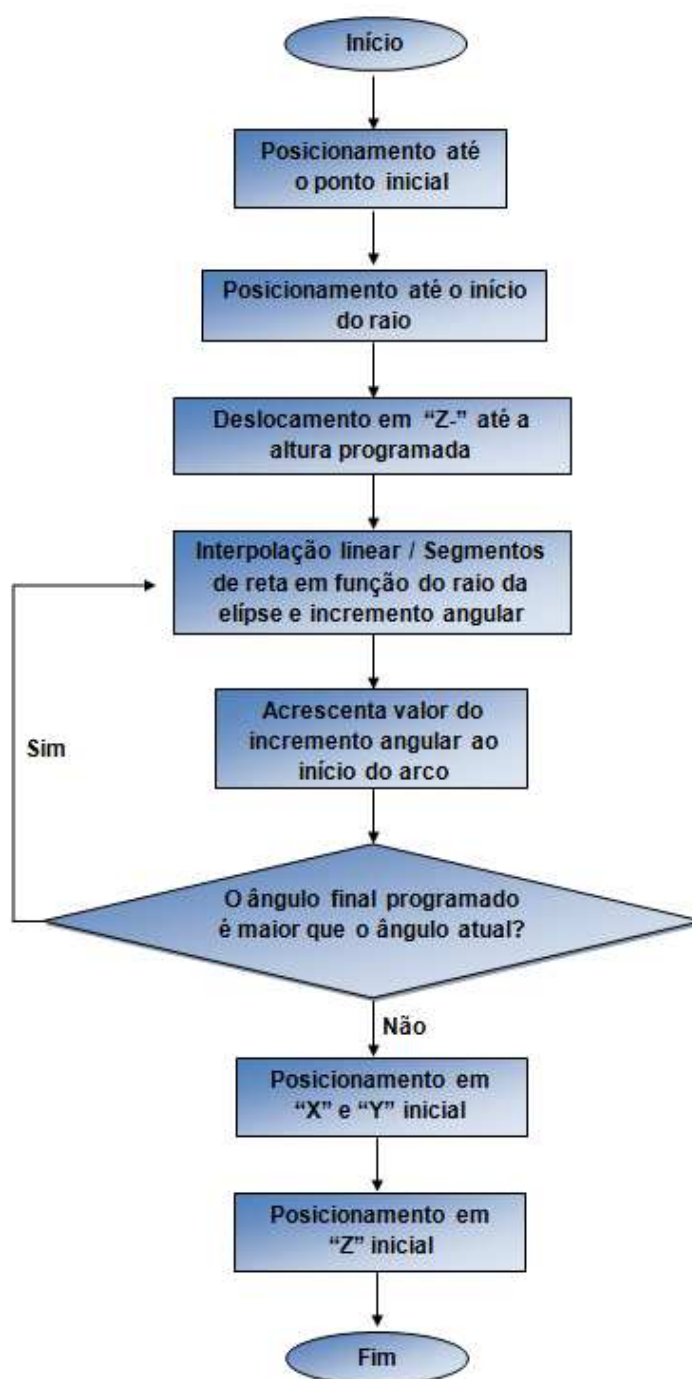
Figura 38 – Fluxograma do programa paramétrico - Elipse.
