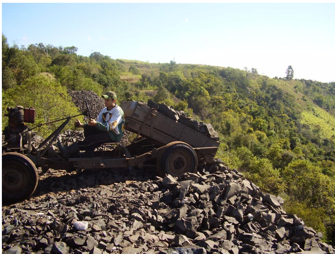
Fonte: Ametista do Sul, 2010. Figura 11: Despejo dos rejeitos nas encostas e taludes
