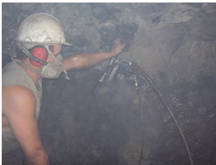
Figura 7: Perfuração da frente de trabalho com injeção de água.
