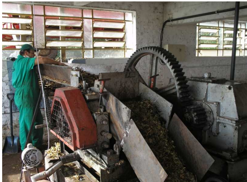
Figura 4.8- Moenda utilizada para remoção do caldo.
