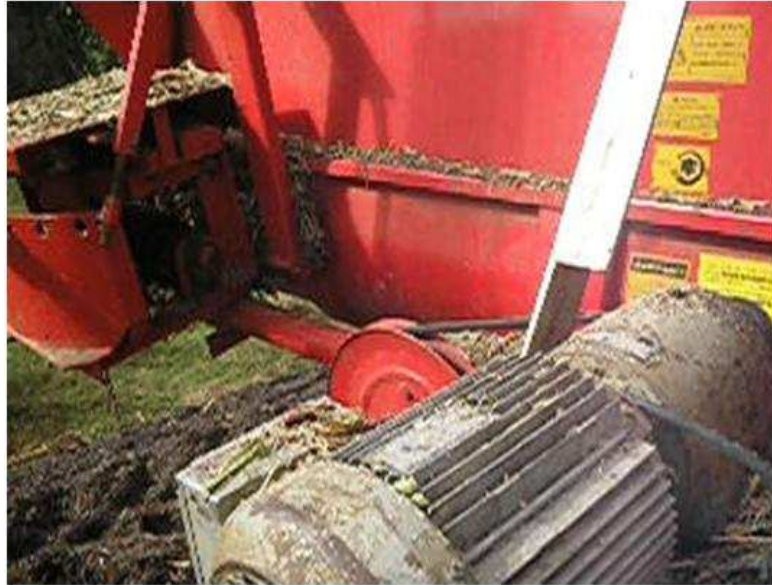
Figura 4.7- Motor elétrico, correias e polias acopladas a carreta ensiladeira para impulsionar o sistema de descarregamento.
