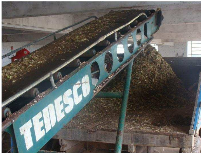
Figura 4.11- Ilustração da esteira transportadora e carreta de armazenagem de material após extração do caldo.
