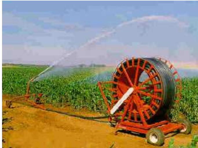
Figura 4.18. Ilustração do carretel enrolador em operação.
