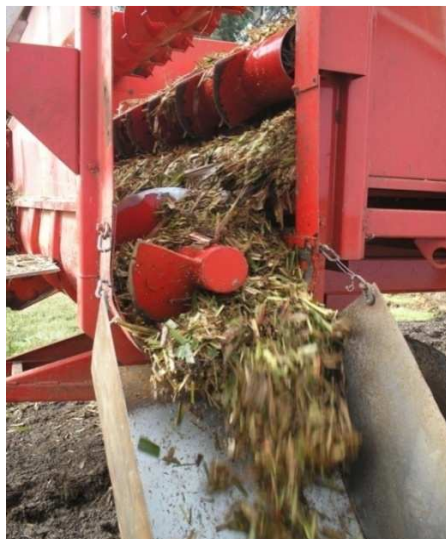
Figura 4.6- Sistema de descarga da matéria-prima pela carreta siladeira. Matéria-prima: sorgo sacarino.
