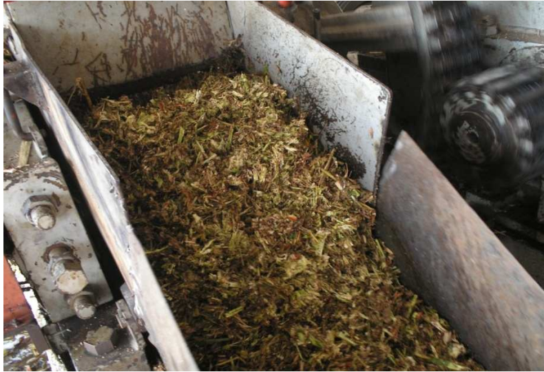
Figura 4.10- Matéria-prima finamente moída (sorgo sacarino) após o processo de remoção do caldo na moenda de três rolos.
