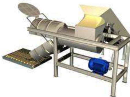
Figura 4.15- Ilustração do sistema de ensilagem da massa verde. Equipamento fabricado pela empresa Sinuelo Genética e Tecnologia Agropecuária, modelo Silo-Pack.
