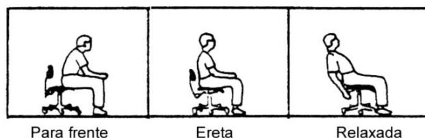
**Figura 5** – Três posições básicas em trabalho estático sentado. Fonte: adaptação de Grandjean (1998, p.48).
