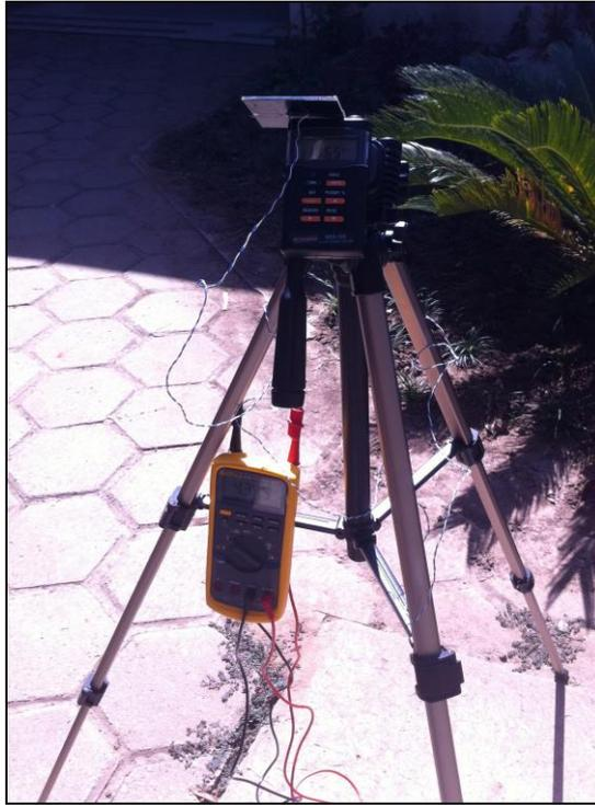
Figura 33 – Célula exposta a radiação direta de  $1025\text{W/m}^2$ .
