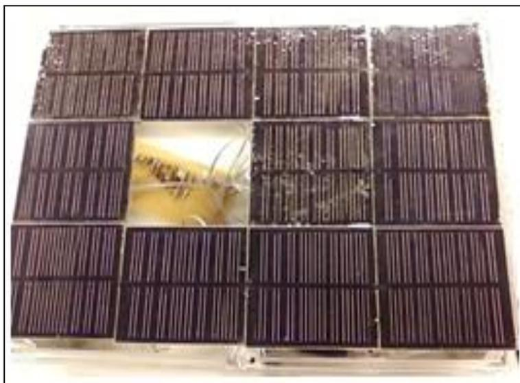
Figura 24 - Matriz solar composta 12 células solares.
