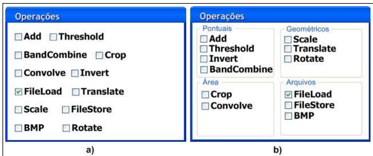
Figura 4.8: a ) Interface gráfica confusa e desorganizada. b ) Uma interface com a mesma eficácia porém organizada através do agrupamento de funcionalidades similares.
