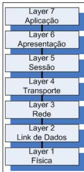
Figura 5.1: Um exemplo de aplicação do padrão arquitetural Layer: o modelo OSI.
