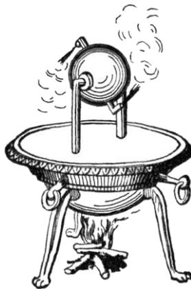
Figura 1 - Aeolipile - Esquema do motor de Hero de Alexandria.
