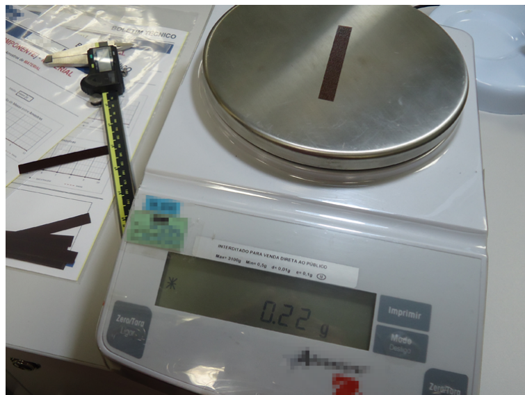
Figura 4.6 – Medida da massa do corpo de prova para determinação de \rho do material utilizado em forma de bobina.
