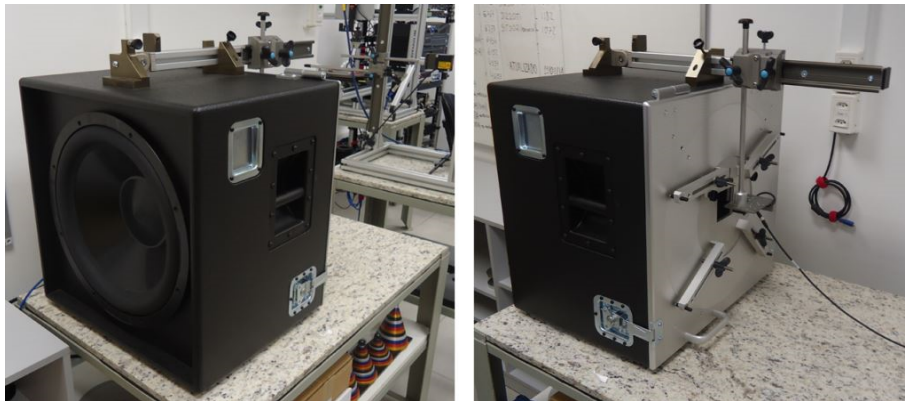
Figura 4.15 – Instrumento de medição das propriedades mecânicas - Módulo MPM da Klippel. Fonte: (Elaborado pelo autor, 2014)
