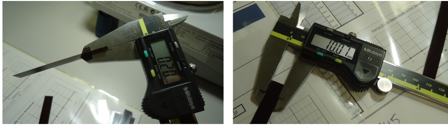
Figura 4.5 – Medida de espessura, comprimento e largura do corpo de prova de material utilizado em formas de bobina.
