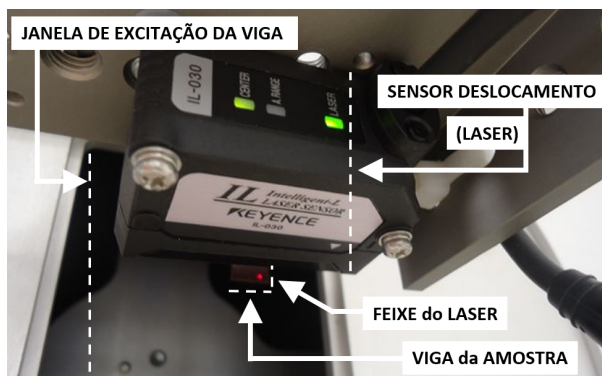
Figura 4.17 – Posicionamento do laser para leitura da vibração do corpo de prova da amostra. Fonte: (Elaborado pelo autor, 2014)
