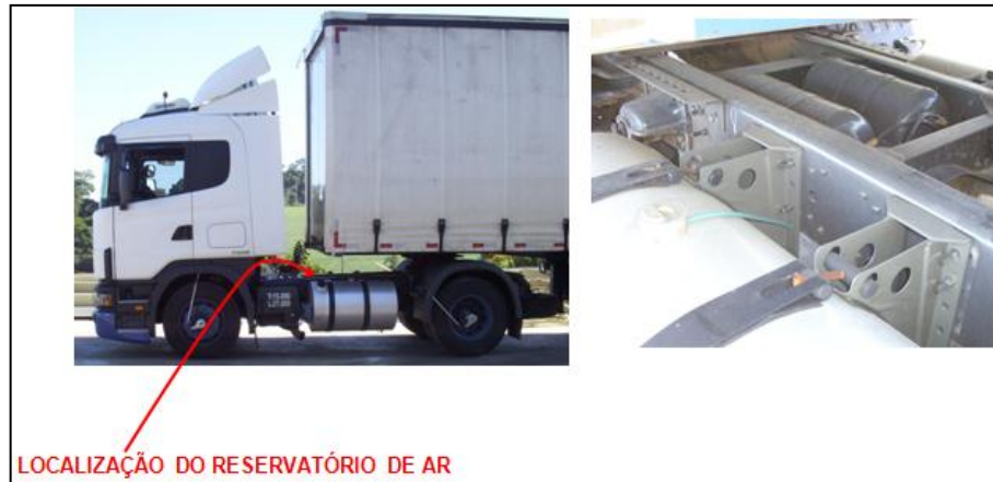
Figura 7 – Aplicação dos reservatórios de ar
