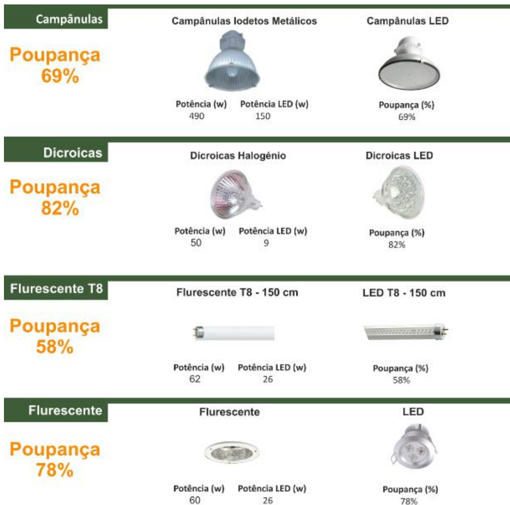
Figura 6 - Substituição de outros sistemas de iluminação por LED.
