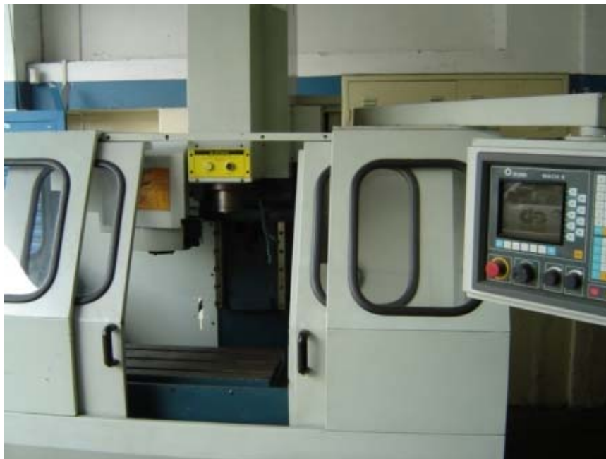
Figura 15 – Centro de usinagem vertical ROMI Discovery 308
