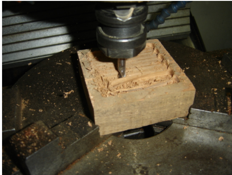
Figura 49 – Seqüência de usinagem da cavidade retangular
