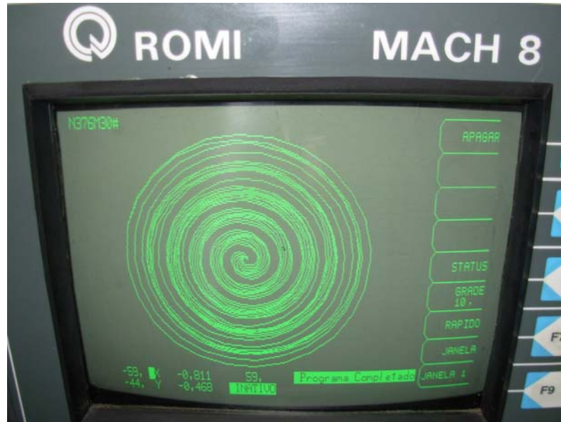
Figura 62 – Movimento espiral gerado pelo comando (X,Y)
