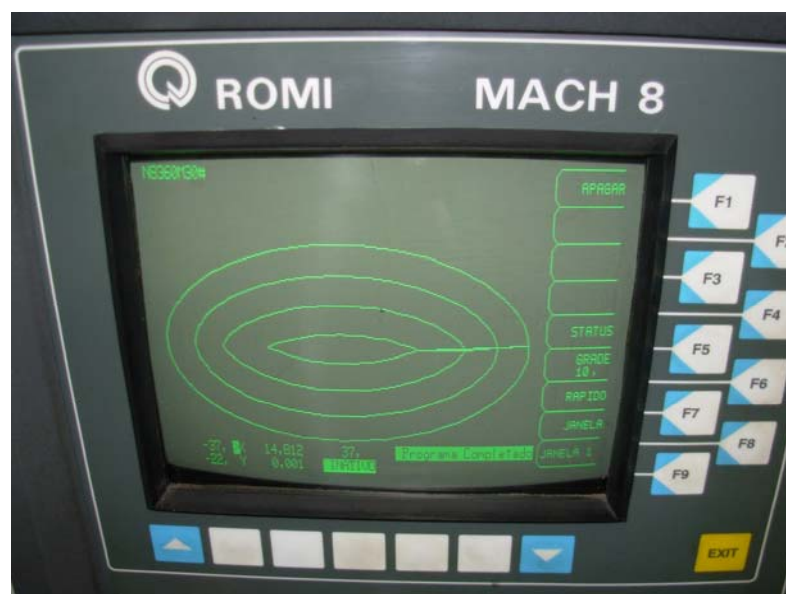
Figura 55 – Traçado elíptico com redução do raio
