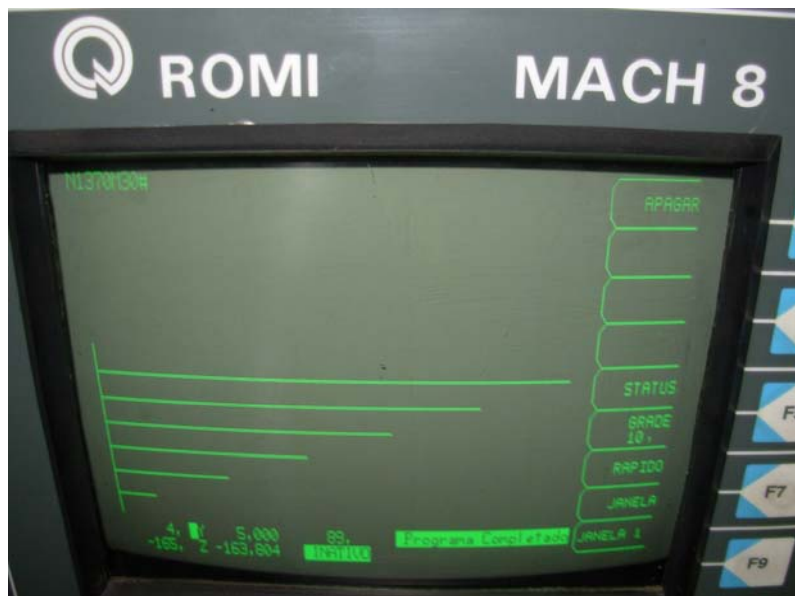
Figura 52 – Traçado da rampa (Y,Z)
