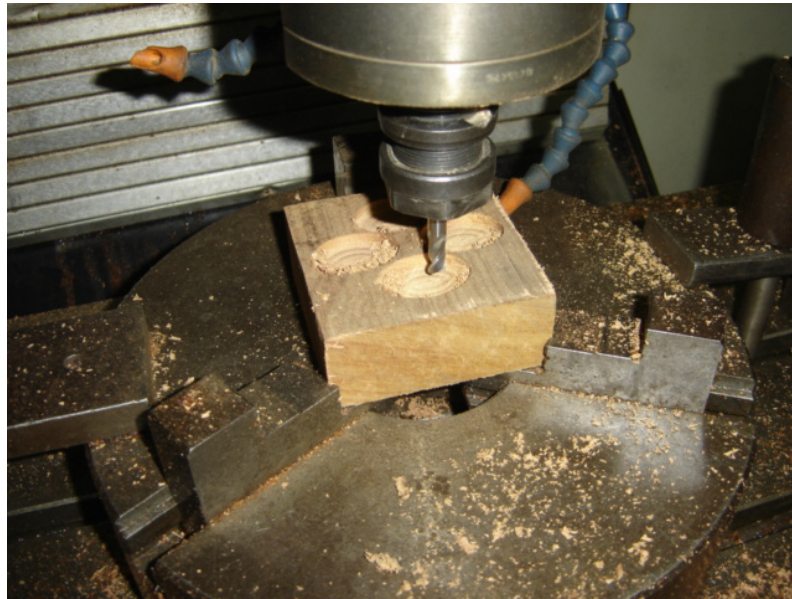
Figura 60 – Sequência de usinagem da cavidade elípticas múltiplas
