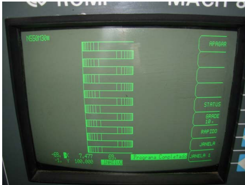
Figura 67 – Simulação gráfica da cavidade circular (X,Y)
