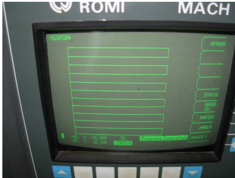
Figura 47 – Traçado para cavidade retangular (X,Y)
