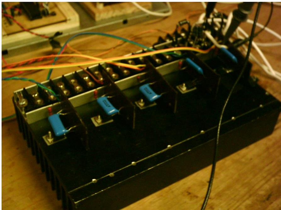
Figura 4.23: Placa de potência do módulo controlador
