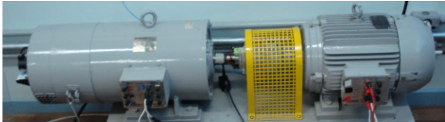
Figura 84: Conjunto motor-gerador utilizado para realização dos ensaios
