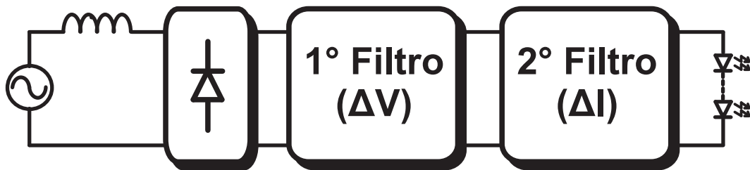
Figura 2.3: Estrutura básica das topologias passivas CC
