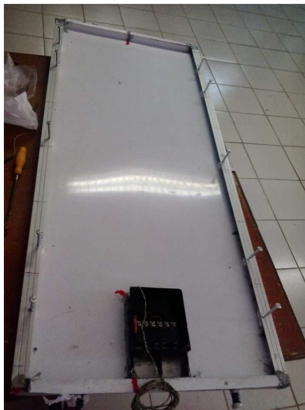
Figura B.3 – Trocador solar -térnico com a chapa de PVC colada na parte traseira afastada por 4 mm
