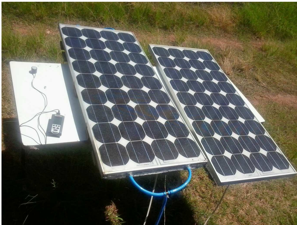
Figura 6.1 – PV de referência à direita e condicionado centro e piranômetro à esquerda
