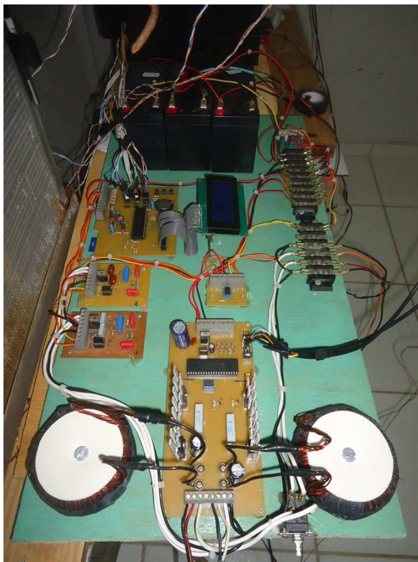
Figura C.1 – Conjunto de circuitos utilizados no controle e placa de aquisição de dados
