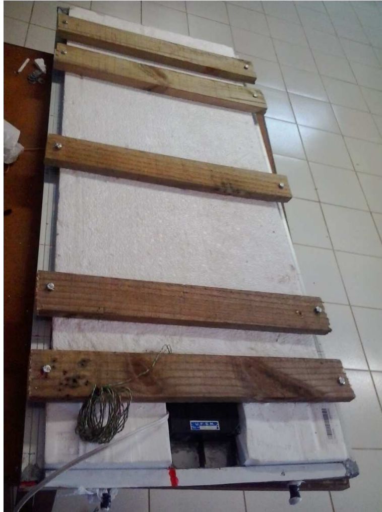
Figura B.4 – Trocador solar- térmico com isolamento e suporte de madeira na parte de trás para evitar a dilatação da chapa
