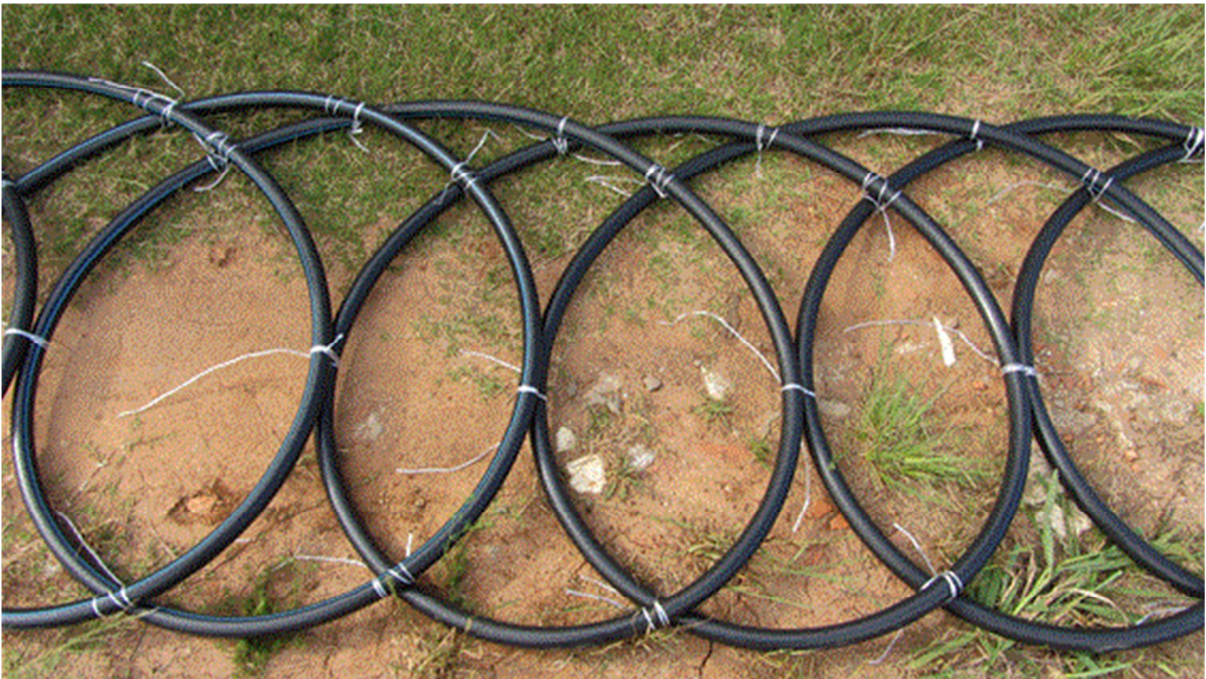
Figura 5.7 - Detalhe da amarração das espiras da mangueira para obter rigidez do conjunto
