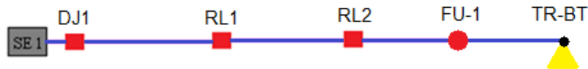
Figura 27 - Exemplo de uma rede de distribuição radial e seus respectivos dispositivos de proteção.
