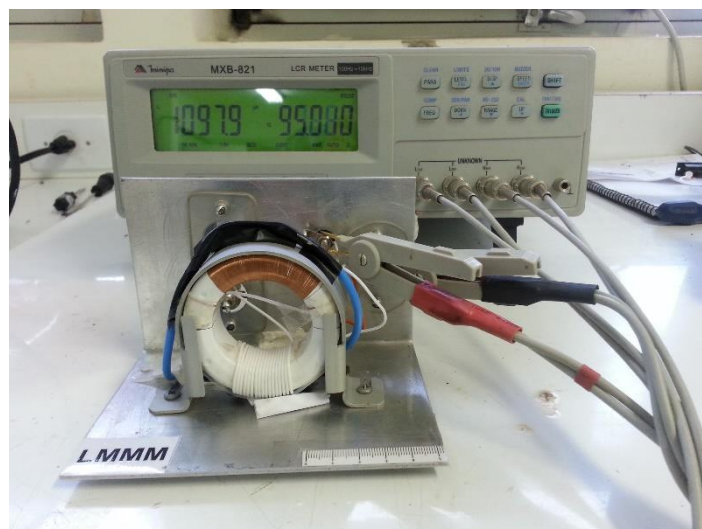
Figura 3.15 – Valor da indutância do núcleo medido experimentalmente
