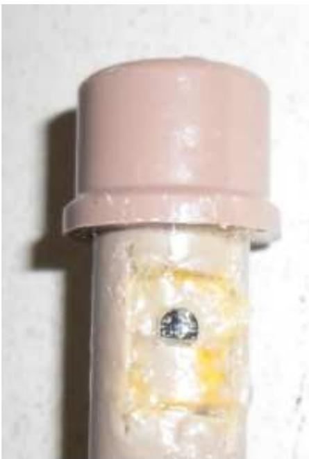
**A - Sensor fixado com resina epóxi**
