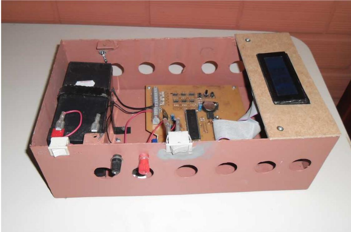
Figura 4.4 - Detalhes construtivos da placa de aquisição de dados.
