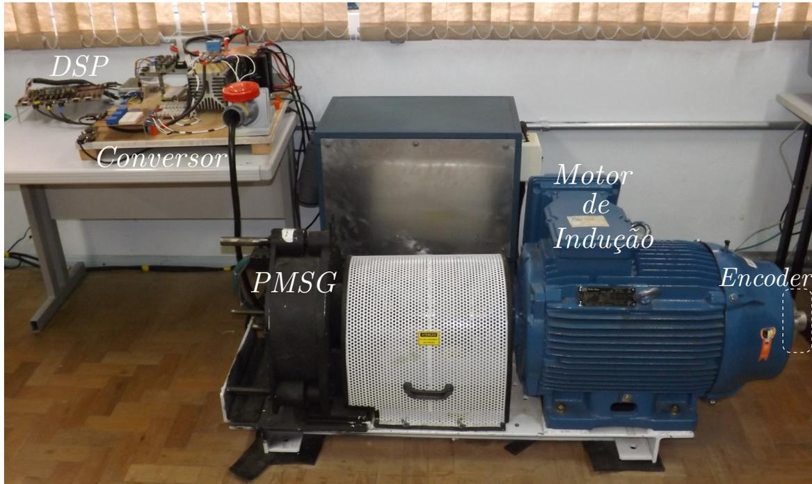
Figura 6.1 – Bancada para ensaios experimentais.
