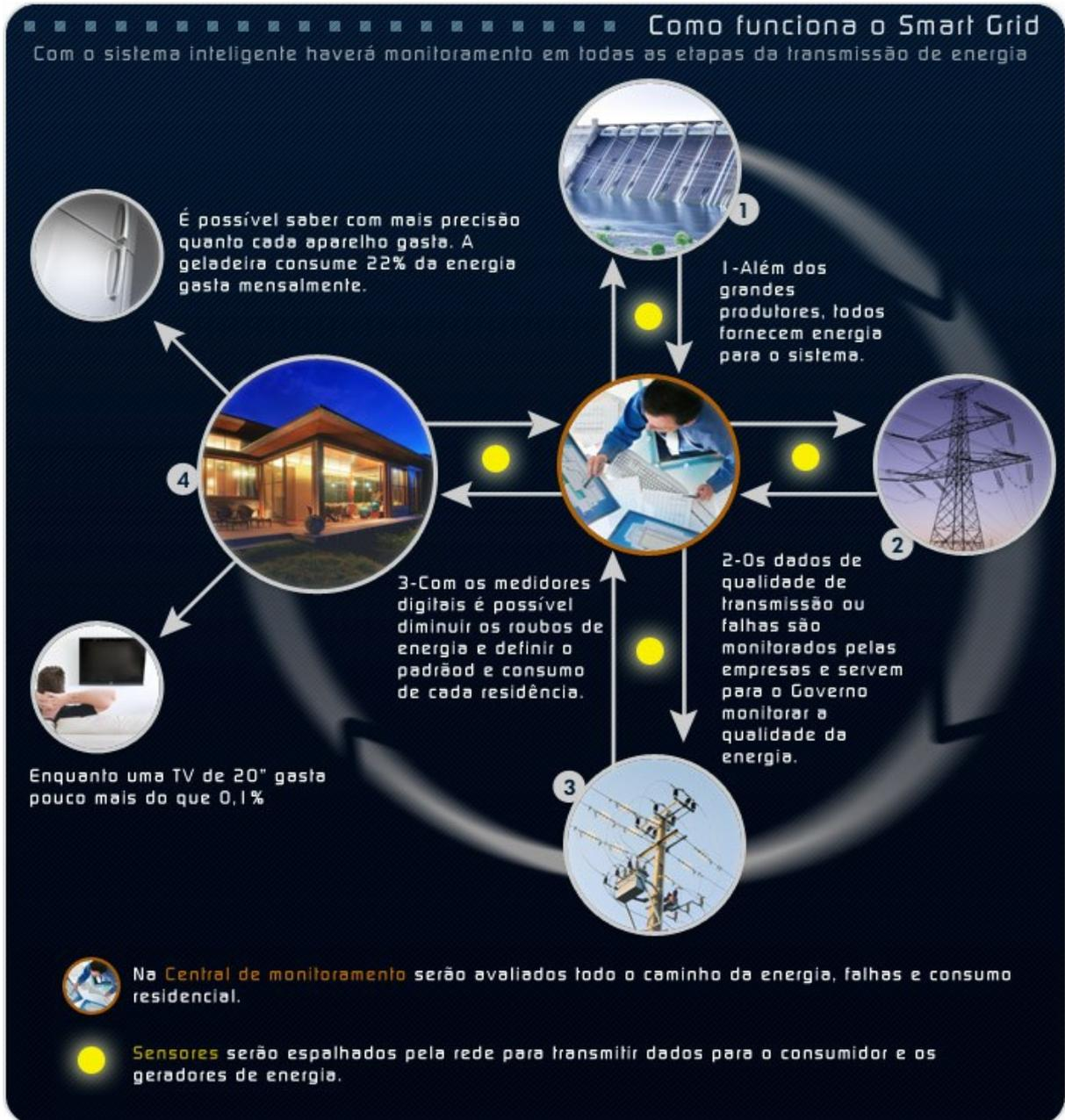
Figura 2.3 - Como funciona o *smart grid*. Fonte: Camargo (2009).
