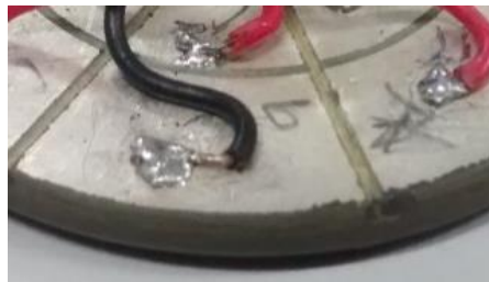
Figura B.4.9 – Detalhes da confecção dos segmentos
