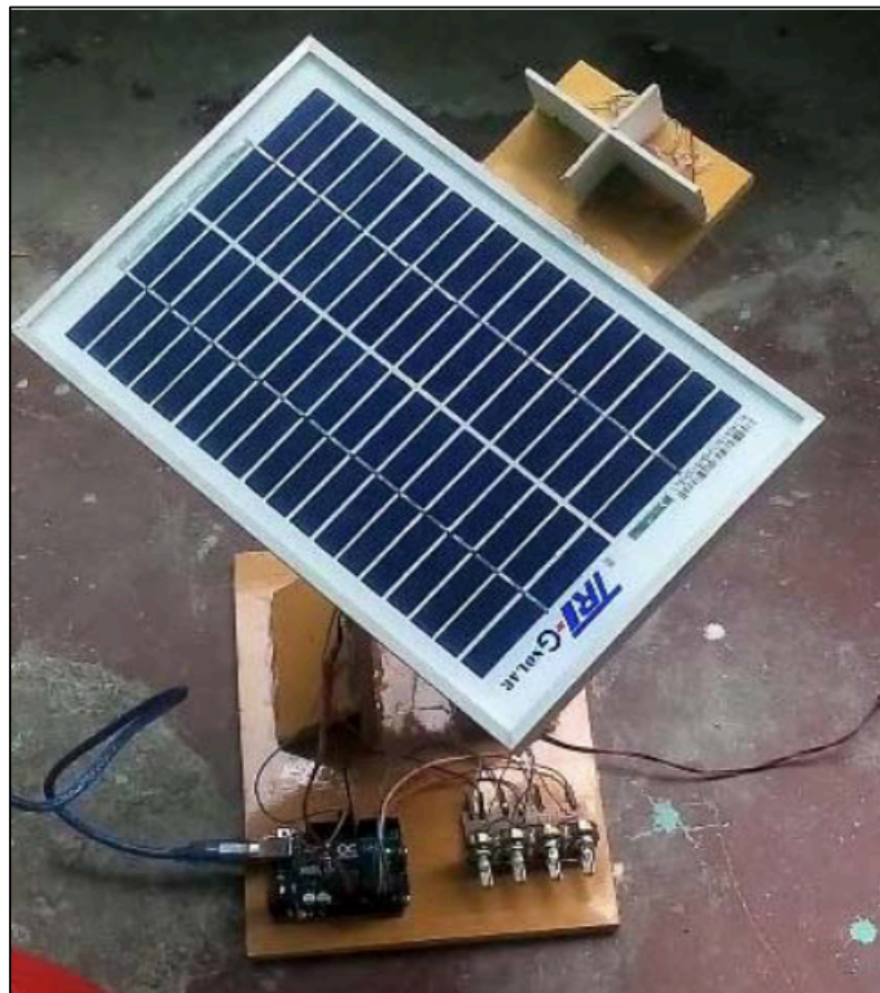
Figura 4 - Rastreador com sensores de luminosidade localizados na mesma base do painel
