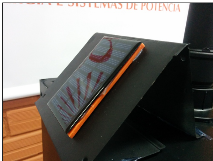
Figura 50 - Painel fotovoltaico fixo em 39 °
