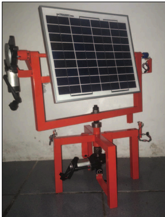
Figura 7 - Rastreador solar para painel policristalino de 10 Wp
