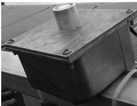
Figura 2.9 – Piranômetro utilizado para medir a irradiância no plano inclinado.
