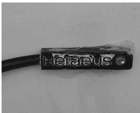
Figura 2.10 – Termorresistências utilizada para medir a temperatura de operação dos módulos fotovoltaicos.
