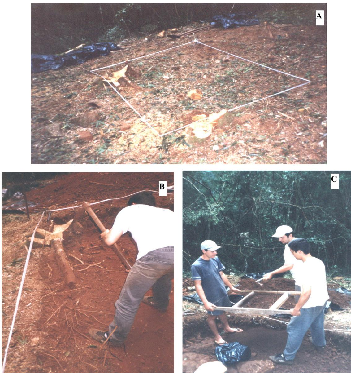
FIGURA 5: Parcela para amostragem de raízes grossas (A); B: escavação para a retirada das raízes e a peneiração (C), que visa separar o solo das raízes escavadas. Santa Tereza, RS. 2003.
