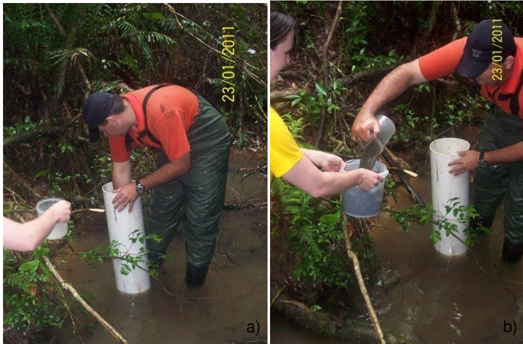
Figura 18 - Agitação do sedimento depositado no canal para que fique em suspensão (a) e coleta do sedimento (b) (Fotos: AMORIM, R. S. S., 23/01/2011).
