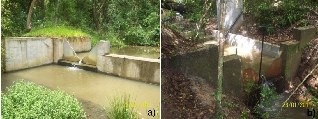
Figura 14 - Seções de monitoramento hidrossedimentológico da Bacia (a) e da Sub-bacia (b) hidrográfica do horto florestal Terra Dura, Eldorado do Sul – RS (Fotos: AMORIM, R. S. S., 23/01/2011).
