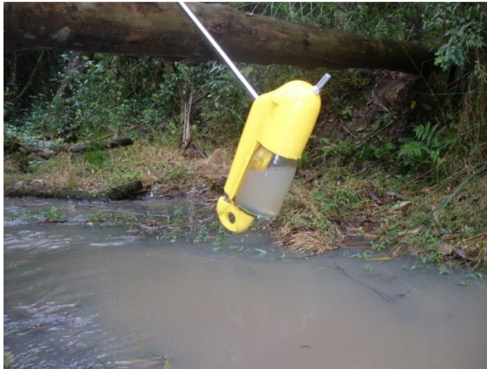
Figura 17 - Amostrador de sedimentos em suspensão, do tipo USDH-48 (Fotos: RODRIGUES, M. F., 31/09/2011).
