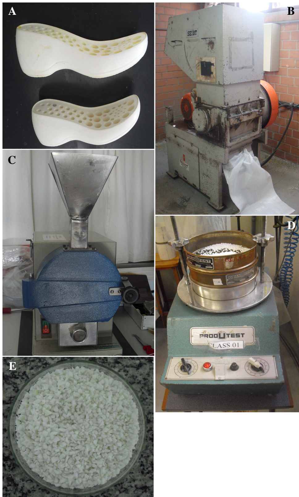
Figura 8 – Processo de obtenção dos sólidos granulares de poliuretano utilizados na confecção dos painéis: solado de poliuretano (A); processamento em moinho granulador (B); processamento em moinho de facas (C); seleção dos grânulos (D); e grânulos obtidos ao final do processo (E)
