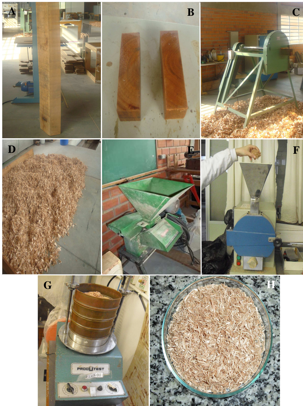
Figura 7 – Processo de obtenção das partículas de madeira utilizadas na confecção dos painéis: tábua de E. grandis (A); blocos de madeira após imersão em água (B); obtenção dos flocos (C); secagem dos flocos (D); processamento dos flocos em moinho de martelos (E); reprocessamento das partículas em moinho de facas (F); classificação das partículas (G); e partículas obtidas ao final do processo (H)
