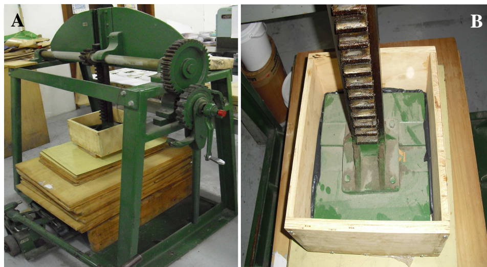
Figura 10 – Prensagem dos painéis: prensa utilizada (A); e detalhe da prensagem (B)
