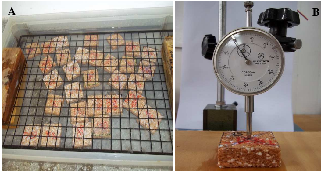
Figura 12 – Imersão das amostras em água (A); e determinação da espessura das amostras com auxílio de relógio comparador (B)
