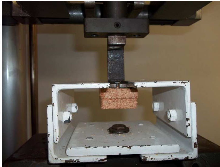
Figura 15 – Ensaio de resistência ao arrancamento de parafuso, realizado de acordo com a norma ASTM D-1037 (1999)
