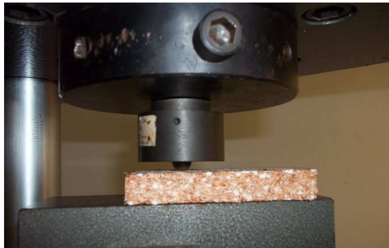
Figura 14 – Ensaio de dureza Janka, realizado de acordo com a norma NBR 14810-3 (2002)
