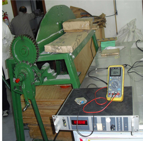
Figura 11 – Célula de carga utilizada na determinação da pressão aplicada durante a prensagem dos painéis
