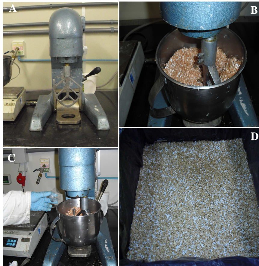
Figura 9 – Confeção dos painéis: argamassadeira (A); incorporação do pré-polímero (B); adição de água (C); e disposição da mistura na caixa (D)
