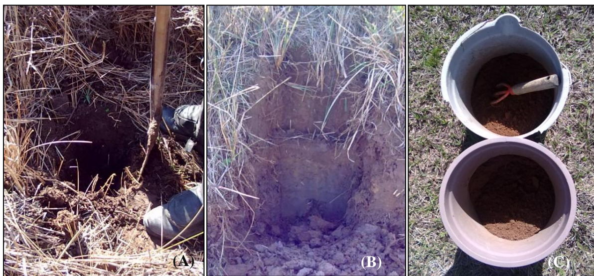
Figura 4.4 – Procedimento de coleta de amostras de solo (A), profundidades de 0-20 e 20-40 cm (B) e homogeneização da amostra composta (C).
