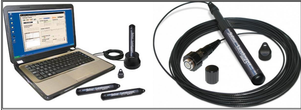
Figura 4.8 – Figura ilustrativa da transmissão dos dados coletados automaticamente dos medidores automáticos para o computador do tipo notebook .
