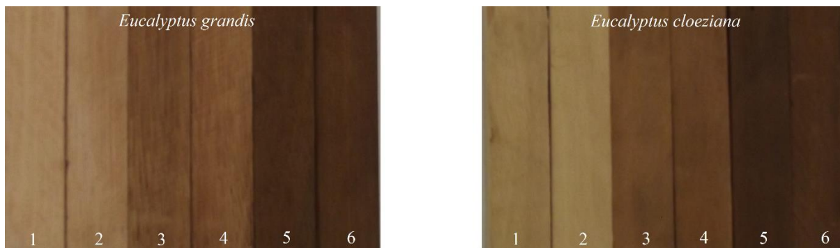
Figura 7.1 – Avaliação visual dos corpos de prova de referência e os tratados termicamente na seção tangencial na madeira de Eucalyptus grandis e Eucalyptus cloeziana . Tratamentos: 1 = M; 2 = MC; 3 = MCT180; 4 = MT180; 5 = MCT200; 6 = MT200.
