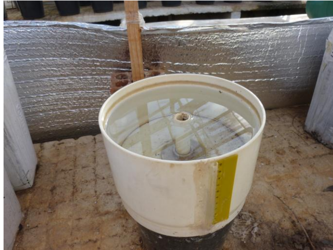
Figura 5 - Mini-tanque usado no monitoramento da evaporação na estufa durante o experimento.
