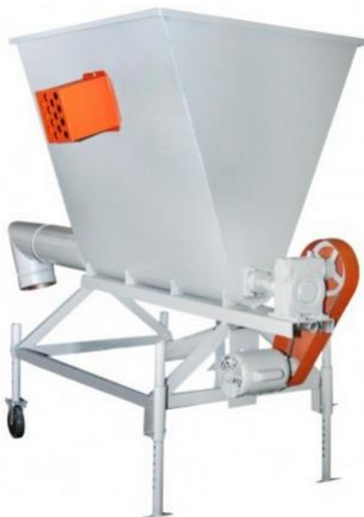
Figura 12 - Sistema de alimentação para unidades de cura de tabaco.
