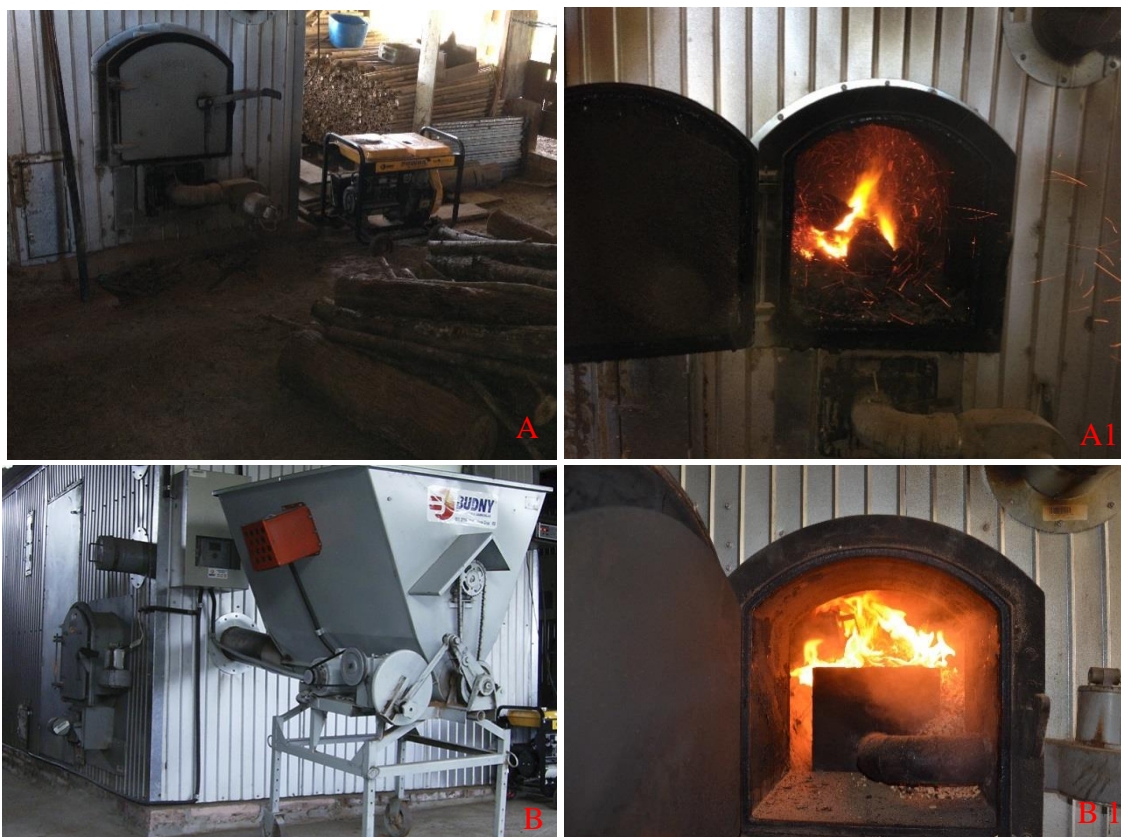
Figura 14 - A: unidade de cura de ar forçado alimentada por lenha; A1: fornalha abastecida com lenha; B: unidade de cura de ar forçado com alimentador acoplado; B1: fornalha abastecida com pellets.
