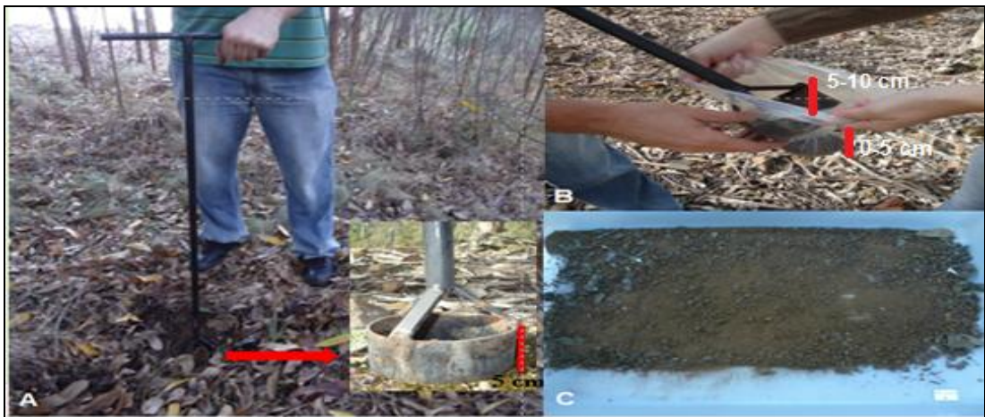
Figura 10 - Sonda circular de 10 x 5 cm 2 (A); armazenamento das amostras de solo para posterior extração da macrofauna (B) e amostras desfragmentadas em laboratório (C).
