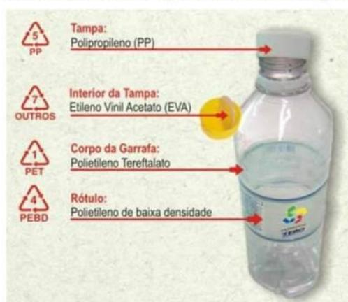
Figura 4 – Tipos de resinas plásticas encontradas no PET.
