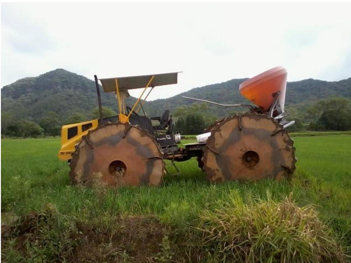
Figura 6 – Trator especial utilizado para semeadura, adubação e pulverização de agrotóxicos nas lavouras de arroz irrigado popularmente conhecido como “chupa-cabra”
