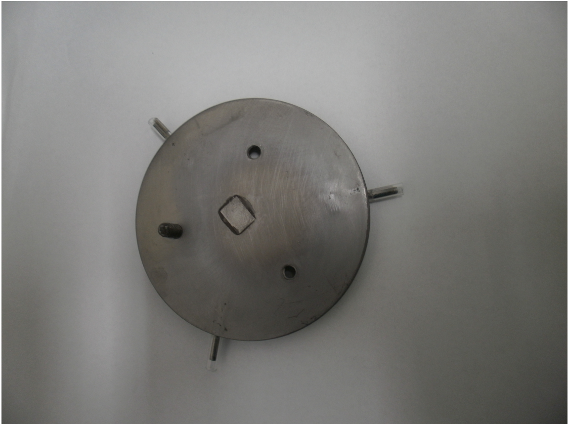
Figura 4.2: Foto do porta substratos utilizado para deposições com "bias" aplicado.
