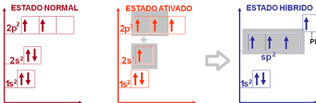
Figura 2.4 – Diagrama energético das diferentes fases do carbono durante o processo de hibridização sp^2 (Adaptado de SOLOMONS e FRYHLE, 2001).
