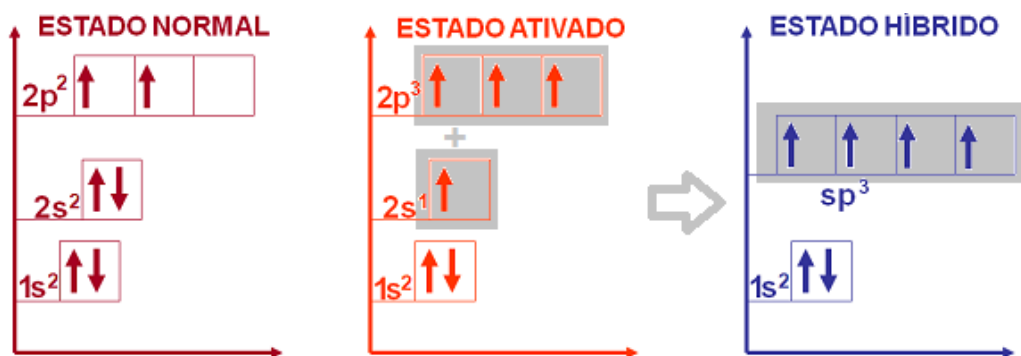
Figura 2.2 – Diagrama energético das diferentes fases do carbono durante o processo de hibridização sp^3 (Adaptado de SOLOMONS e FRYHLE, 2001).
