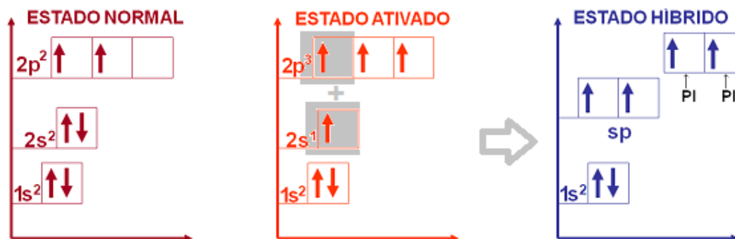
Figura 2.6 – Diagrama energético das diferentes fases do carbono durante o processo de hibridização sp (Adaptado de SOLOMONS e FRYHLE, 2001).
