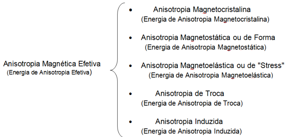
Figura 2.7 – Anisotropias magnéticas e energias de anisotropias associadas (adaptado de [5]).
