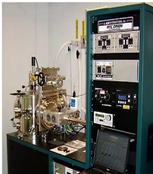
Figura 5.2 – Magnetron Sputtering do Laboratório de Conformação Nanométrica da UFRGS.
