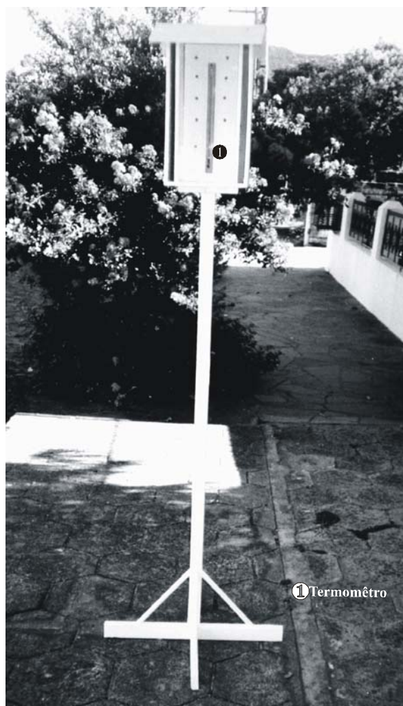
FIGURA 10: Fotografia do mini-abrigo meteorológico
