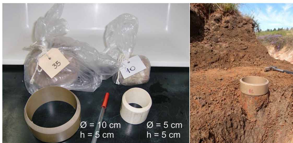
Figura 6 - Anéis utilizados para a coleta de amostras indeformadas.
