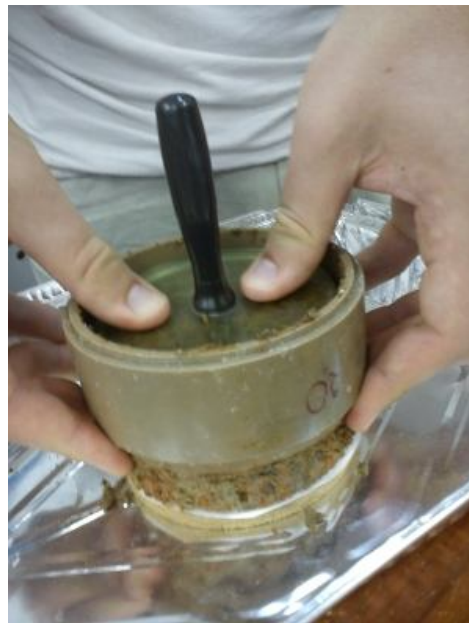
Figura 7 - Retirada da amostra do anel para o ensaio de desagregação.
