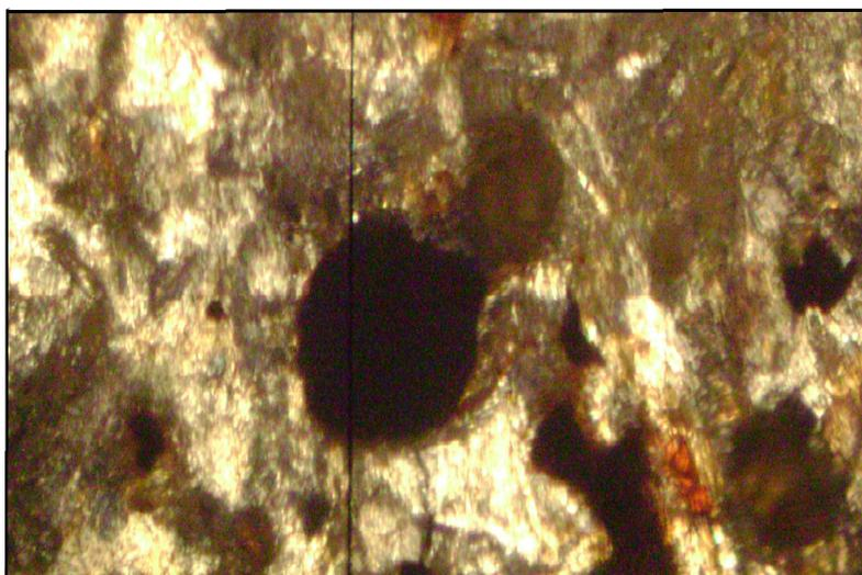
Figura 3.5.4: Fotomicrografia a luz polarizada (2,5X LN, dimensões do campo: 3,6 x 5,4mm) de uma amostra de topo/base de derrame. A área circular no centro da foto ilustra alteração dos minerais. Presença de vidro vulcânico em processo de desvitrificação para argilomineral.
