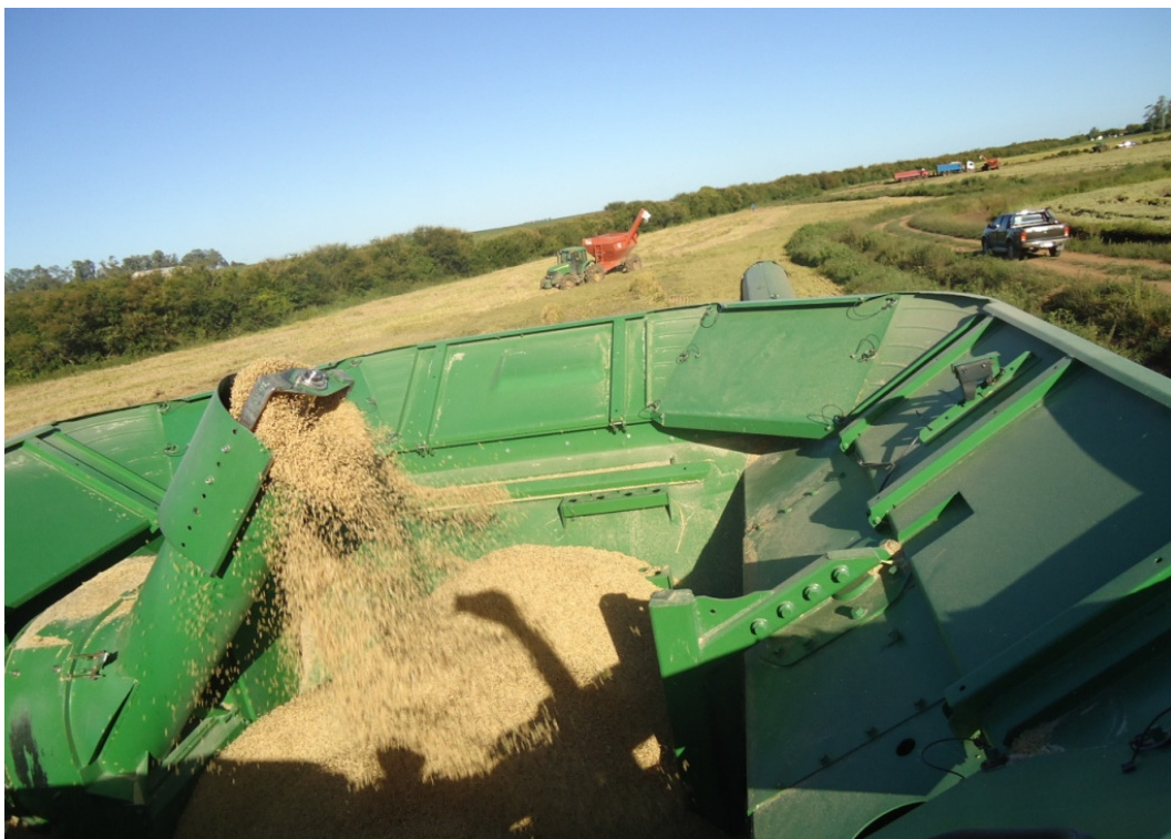
Fotografia 14 – Detalhe do arroz colhido chegando à caixa de armazenamento da colheitadeira.
