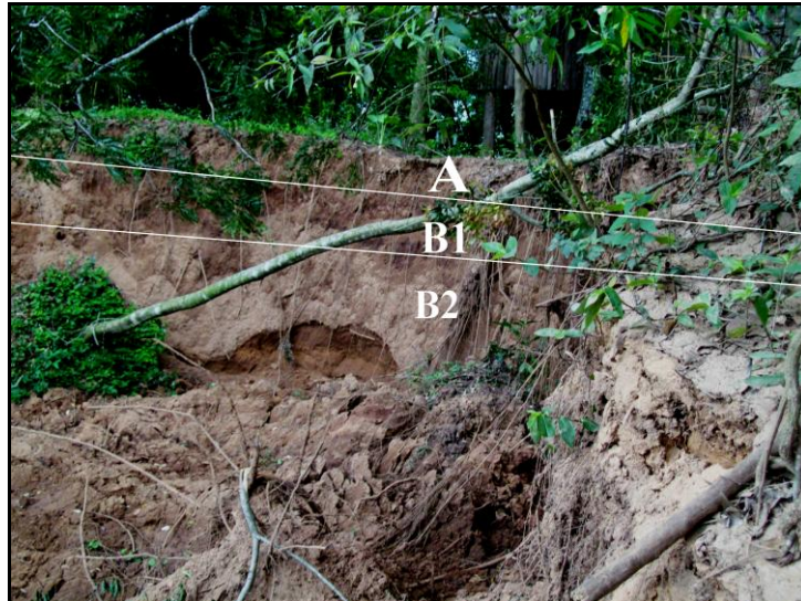
Figura 46: Perfil de solo do tipo Planossolo, próximo ao Rio Jacuí, com processos erosivos. Org: Schirmer, 2012.
