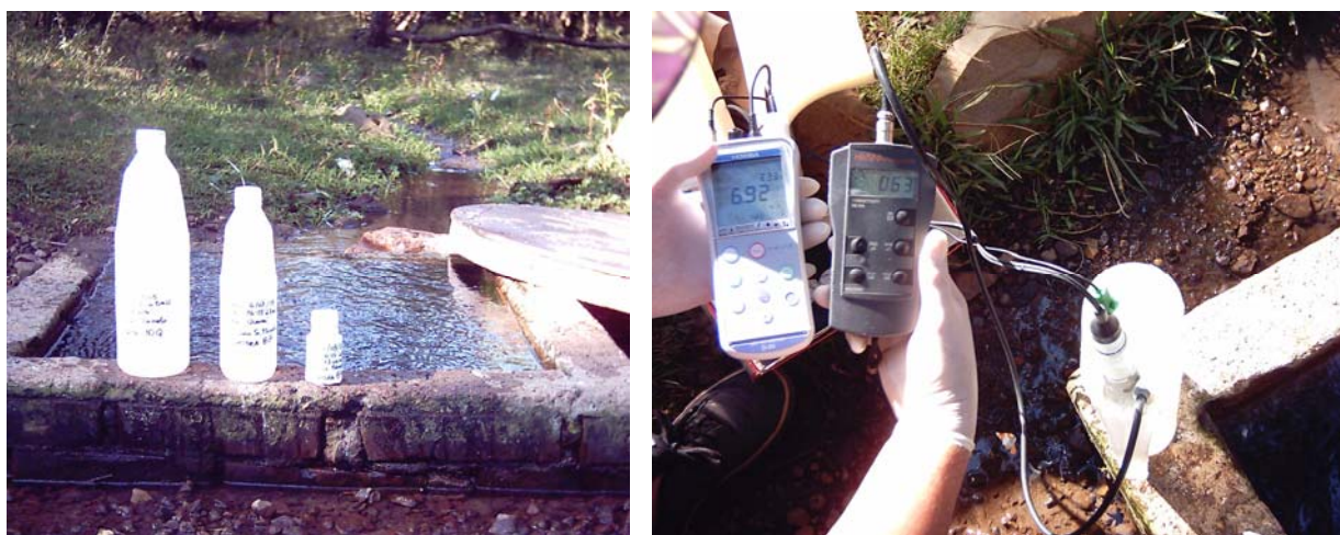
Figura 14 – Poço selecionado para coleta de amostra d' água e recipiente de armazenamento com seus respectivos equipamentos utilizados para medir parâmetros de campo.
