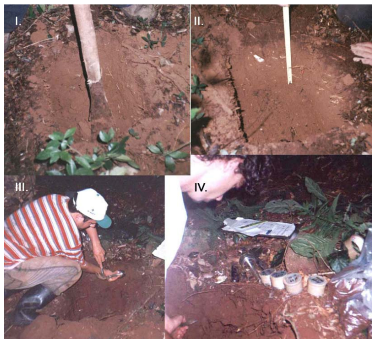
FIGURA 11 - Fases de coleta de solo I) Abertura da trincheira; II) Medição da profundidade; III) Coleta para as análises físicas com anel de Kopecky; IV) coleta para análises químicas, com uso de espátula.
