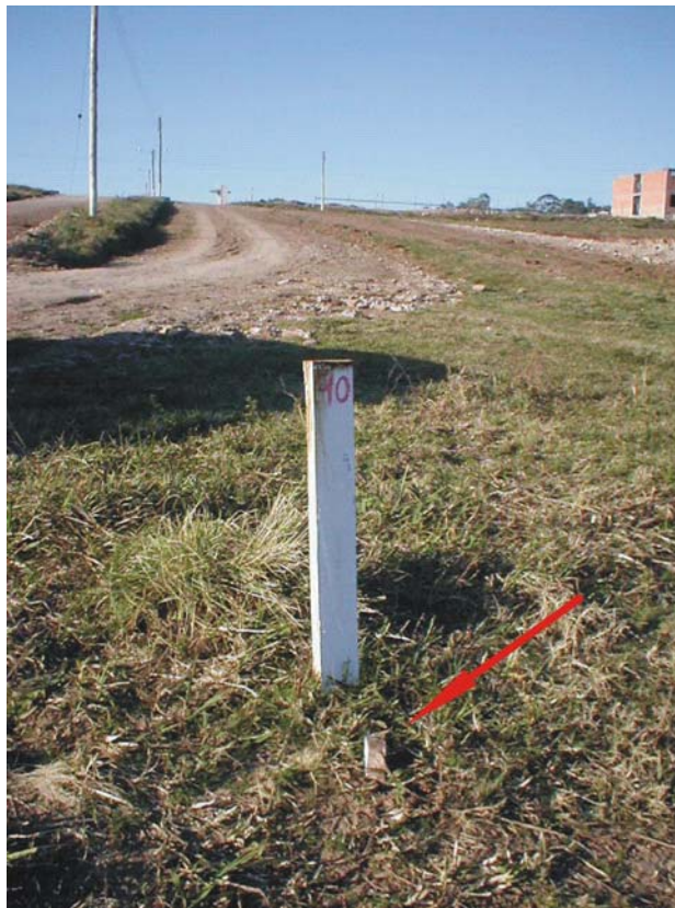
Figura 10 – Estaca nº 10 e piquete e em um ponto pertencente a poligonal demarcada por topografia convencional.
