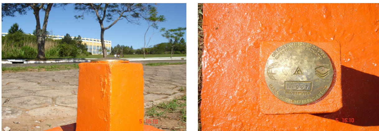
Figura 05 - Detalhes construtivos e identificação dos marcos da rede GIS UFSM. Fonte o autor.
