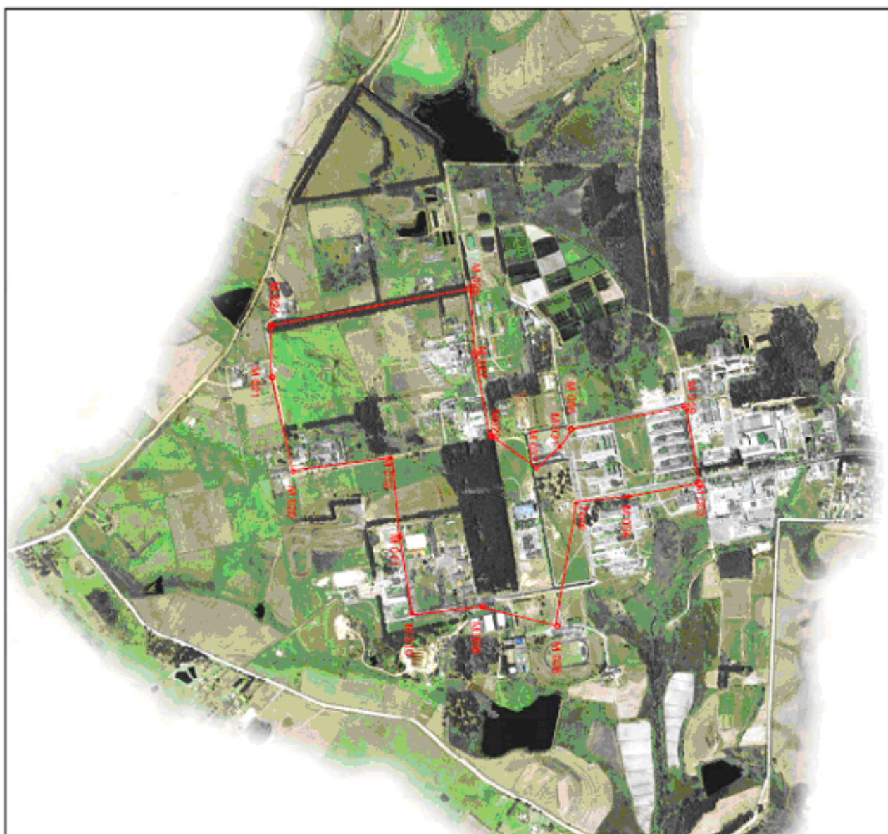
Figura 06 - Vértices da poligonal selecionada no campus da UFSM - Imagem Ikonos 2, 13:44, 15/12/2004. Departamento de Engenharia Rural.
